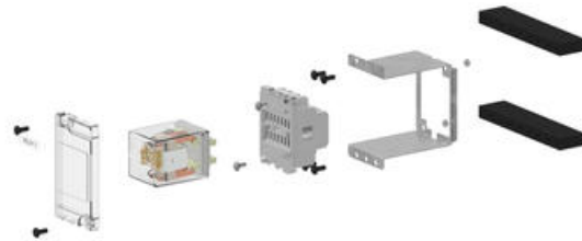
Bild 4 visar spränkskiss på ingående komponenter.
