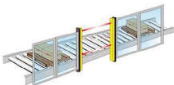
Kroppsskydd med 2 strålar (skyddsfält 500 mm)
