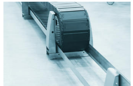
3. Kedjans övre del lägger sig då på rullstöden
