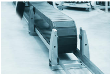
1. Kabelkedjan passerar de svängbara hjulen endast med sin radie
